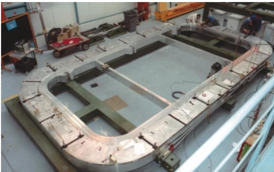
Bobine BO, maquette des bobines du toroïde ATLAS. Dimensions : 8 x 3 mètres. Chacune des huit bobines définitives fera 25 x 8 mètres.
