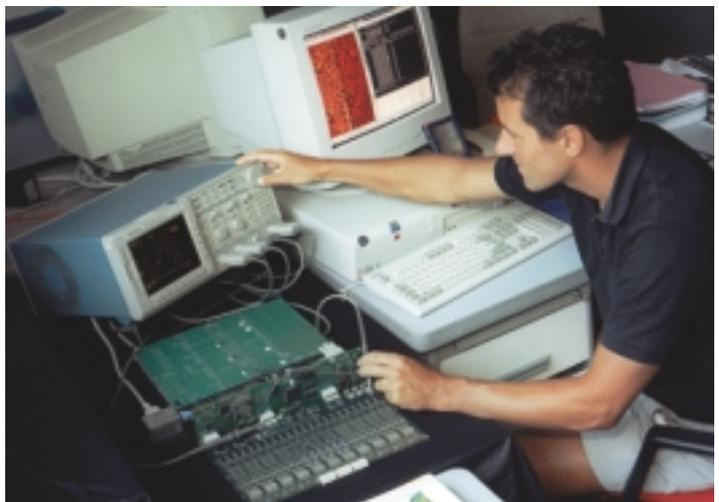
Photo du haut : montage d'une caméra CCD pour EROS, expérience d'astroparticules. Photo du bas : test du contrôleur multi-CCD pour MEGACAM, instrument d'astrophysique. C'est en construisant les caméras CCD pour EROS que le DAPNIA a acquis le savoir-faire indispensable au développement de la caméra géante MEGACAM.
