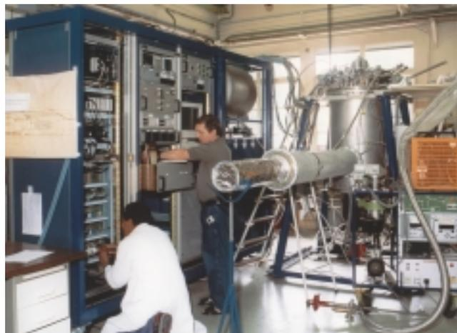
**Cible cryogénique de CLAS (voir page 8) avec son système de contrôle-commande et instrumentation associée. Cette expérience utilise localement le réseau deterrain WorldFIP et le réseau Internet pour la supervision à distance**
