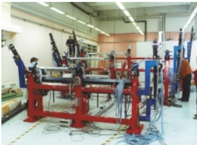
**DATCHA, laboratoire de développement et de caractérisation des systèmes d'alignement optique pour les chambres à muons de l'expérience ATLAS, on vise un alignement précis à 20 µm sur 20 mètres de distance.**
