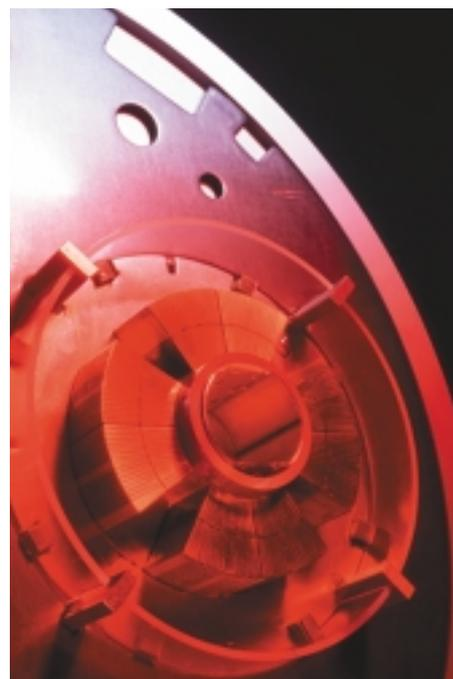
Un quadrupôle pour LHC. Le faisceau passe par le tube dont on voit une extrémité (diamètre intérieur : 56 mm).
