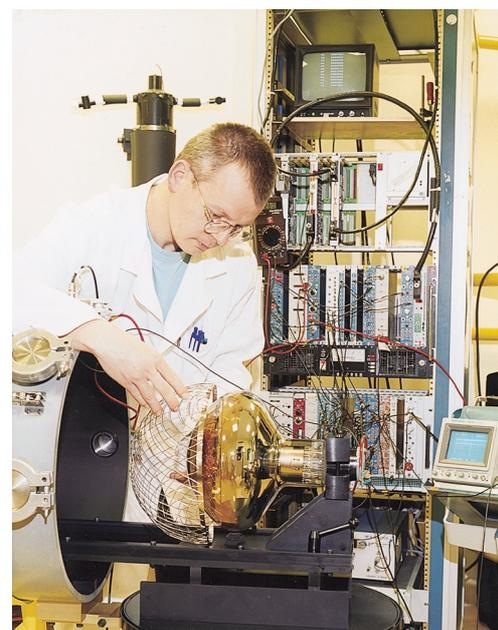
Banc de caractérisation des photomultiplicateurs et modules optiques du détecteur Antarès (SED, SGPI, SIG, SPP).
