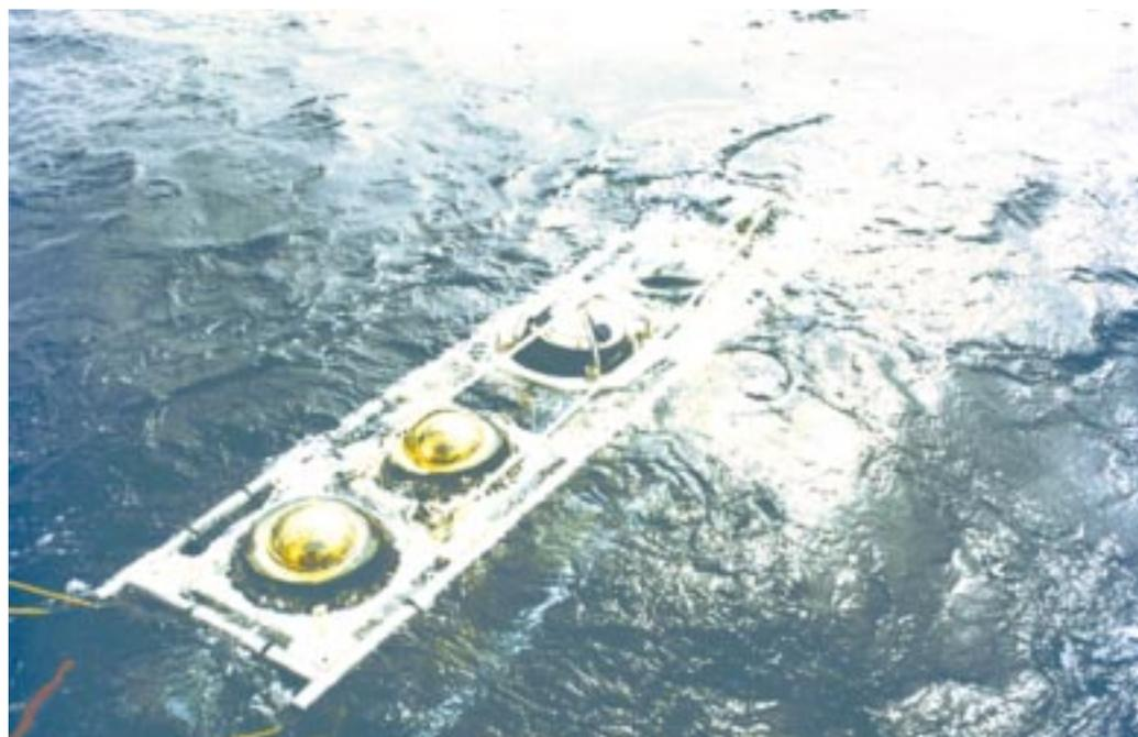
*Projet ANTARES : modules optiques de la ligne de test du bruit de fond optique, en cours d'immersion au large de Toulon.*
