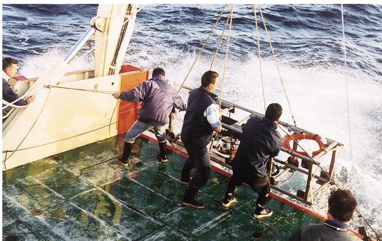
Immersion d'une ligne instrumentée autonome pour mesurer le bruit de fond optique sur le site du détecteur Antares au large de Toulon (SEI, SIG SPP).
