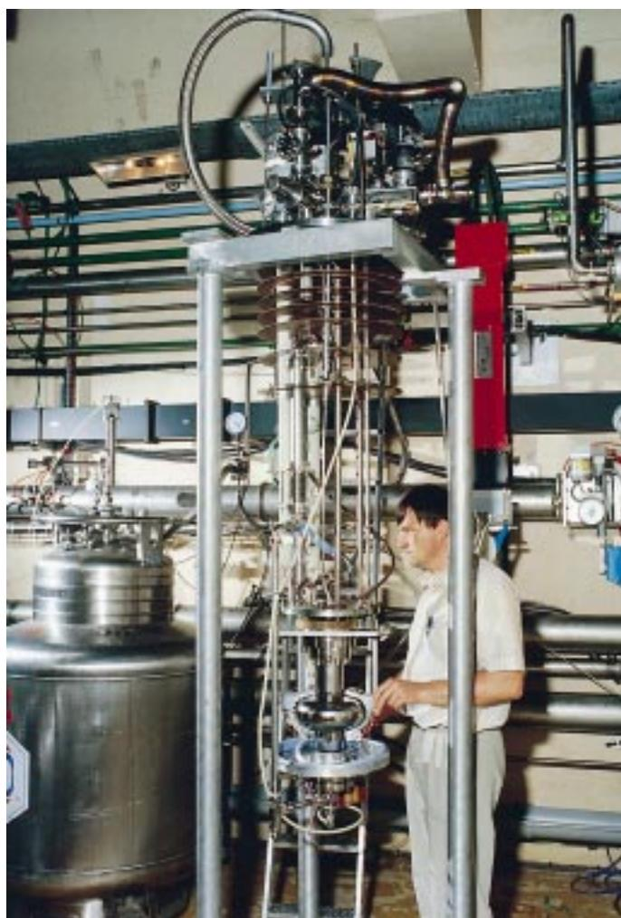
*Cavité accélératrice supraconductrice et son dispositif cryogénique, dans la salle d'essais du SEA*
